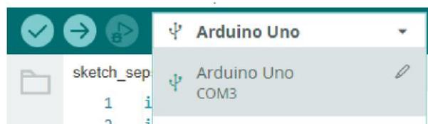
En la parte superior del programa se encuentra el apartado para poder verificar, cargar el código, y seleccionar la placa y el puerto en el que se encuentra conectado la tarjeta.
