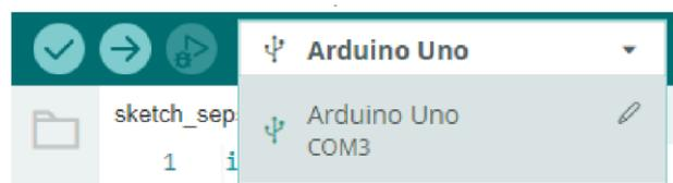
En la parte superior del programa se encuentra el apartado para poder verificar, cargar el código, y seleccionar la placa y el puerto en el que se encuentra conectado la tarjeta.
